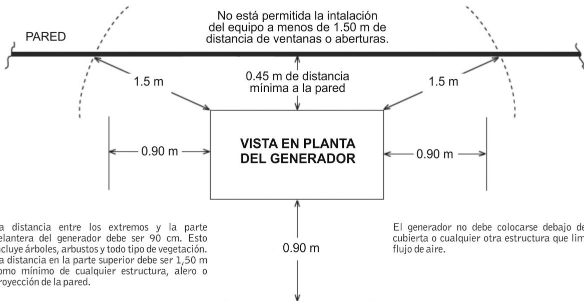
La distancia entre los extremos y la parte delantera del generador debe ser 90 cm. Esto incluye árboles, arbustos y todo tipo de vegetación. La distancia en la parte superior debe ser 1,50 m como mínimo de cualquier estructura, alero o proyección de la pared.
